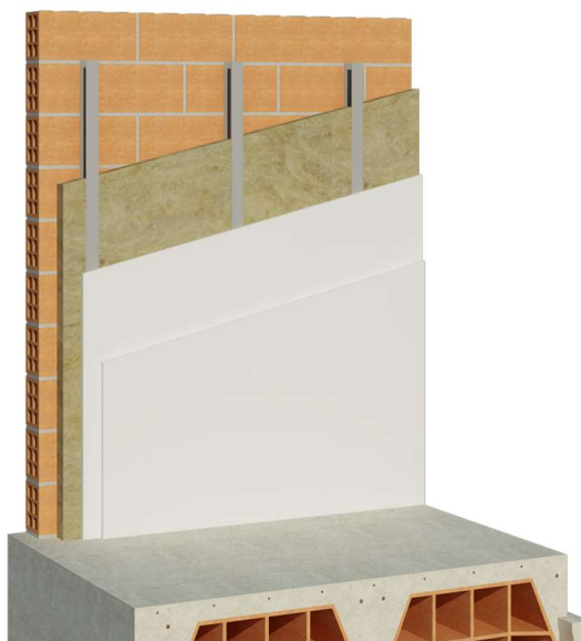
Figura 21. Trasdoso con placa de yeso laminado
